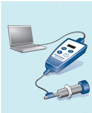
传感器通过LCA-2连接到电脑进行编程
