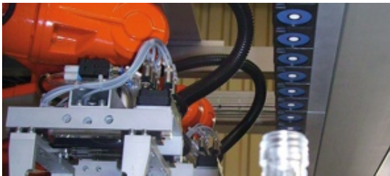
玻璃瓶生产工艺中的同步传感器单元
