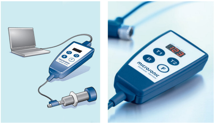
传感器通过LCA-2连接到电脑进行编程
