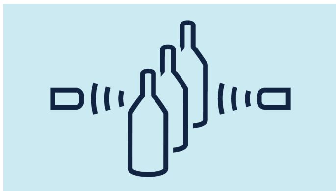
超声波对射传感器的工作原理
